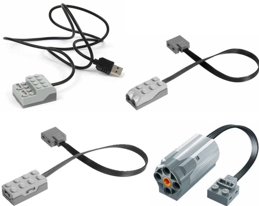
Obr. 50: Rozhraní USB Hub, senzor pohybu, senzor náklonu a motorová jednotka (Zdroj: Bricklink.com)
