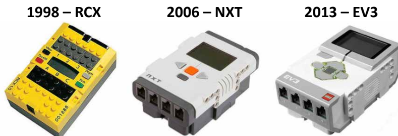
Obr. 68: Vývojová řada řídicích kostek LEGO s datem uvedení na trh (Zdroj: Robowiki.spsnome.cz)
