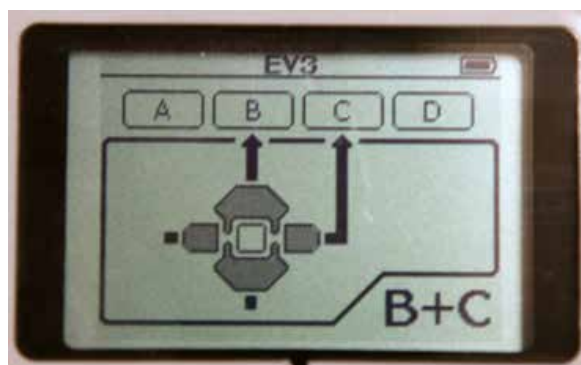
Obr. 77: Kostka EV3 – menu Motor Control (ovládání motorů), zde ovládání motorů na portech A a D / B a C (Zdroj: autoři)
