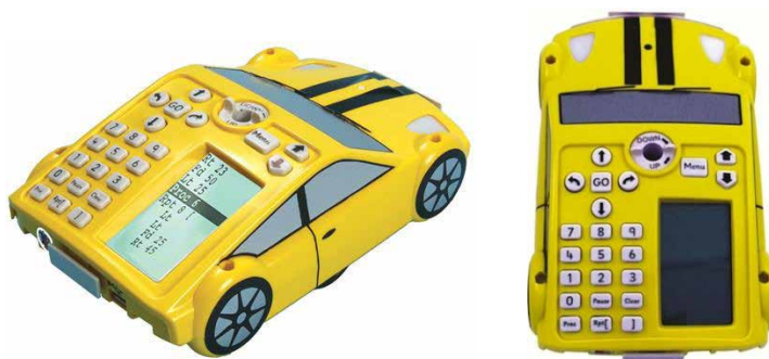
Obr. 13: Inteligentní kreslící autíčko Pro-Bot + rozložení ovládacích tlačítek (Zdroj: Terrapinlogo.com)
