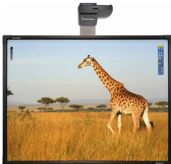
Obr. 113: Interaktivní tabule ActivBoard Touch využívající kombinaci elektromagnetické indukce a infračerveného záření (Zdroj: Stemtech.it)
